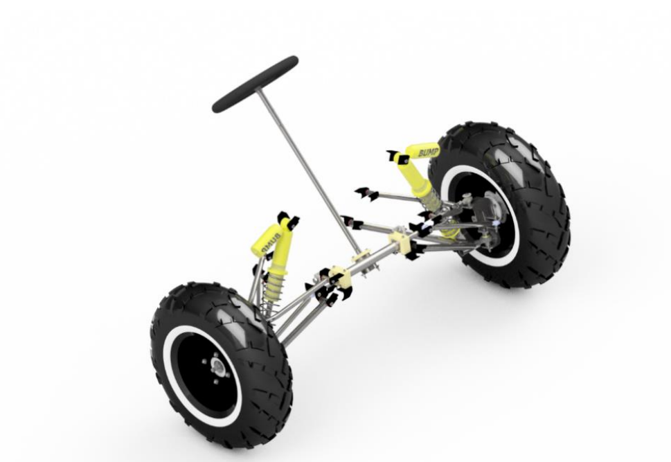
Figura 25: Modelo 3D da suspensão dianteira e direção
