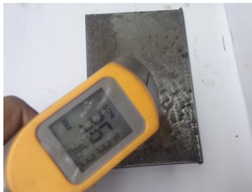
Figura 5 – Corpo de prova em temperatura ambiente.
