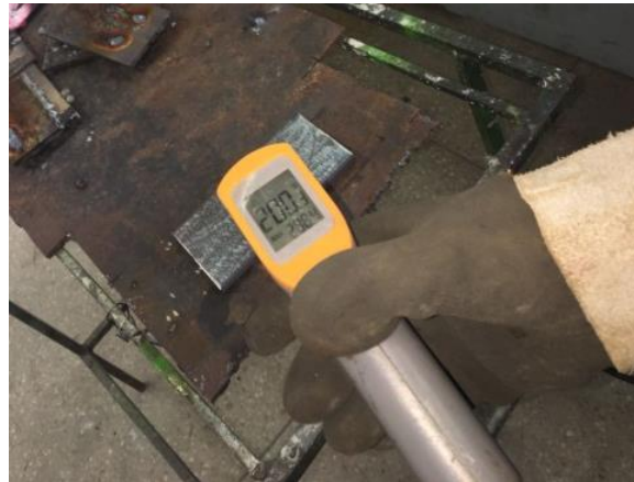
Figura 7 – Corpo de prova a 200°C.
