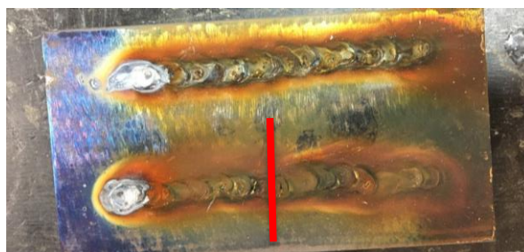
Figura 8 – Local do corte na seção transversal do cordão.
