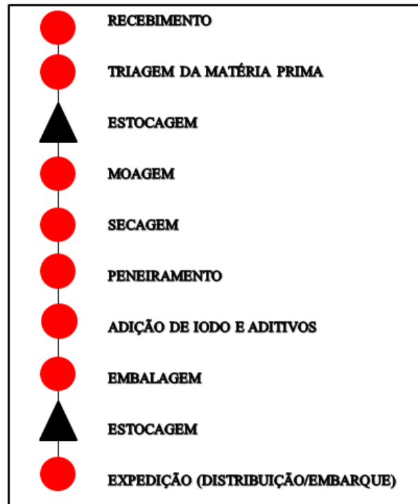
Figura 16 – Fluxograma do Sistema Produtivo do Sal Refinado
