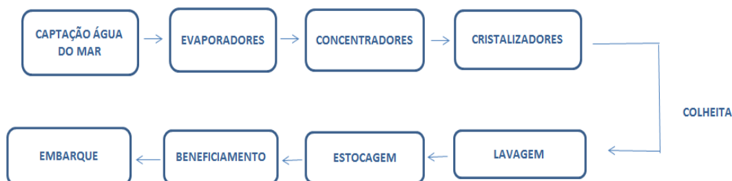
Figura 4 – Diagrama em blocos representando o processo de coleta do sal
