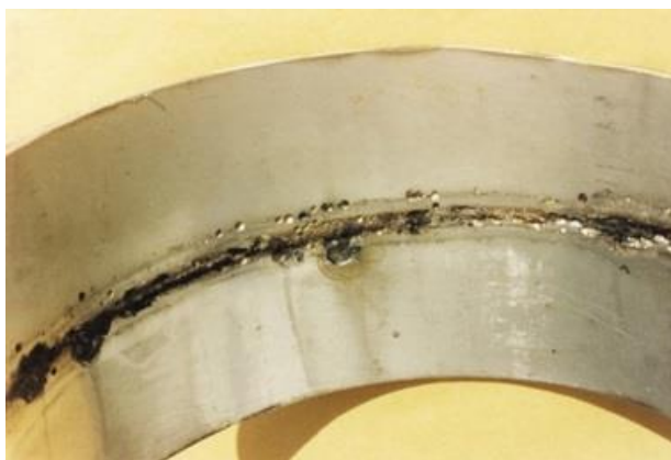
Figura 15: Corrosão Em torno do cordão de solda
