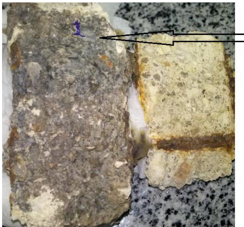
Figura 36: aplicação do nitrato de prata para a avaliação da presença de cloretos.
