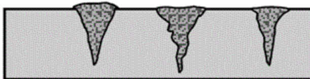
Figura 7: Corrosão por Pite
