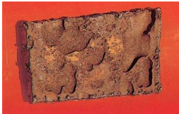
Figura 5: Corrosão por Placas
