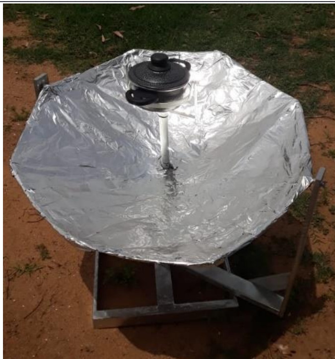
Figura 3: Fogão solar parabólico. (Adaptado de [2])
