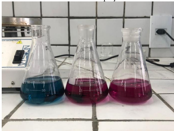
Figura 5. Coloração obtida na viragem do procedimento de determinação do percentual de íons de magnésio na amostra de água-mãe. (Autoria própria)
