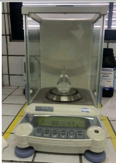
Figura 3. Medição do volume do picnômetro não graduado com água para determinação da densidade da água-mãe. (Autoria própria)
