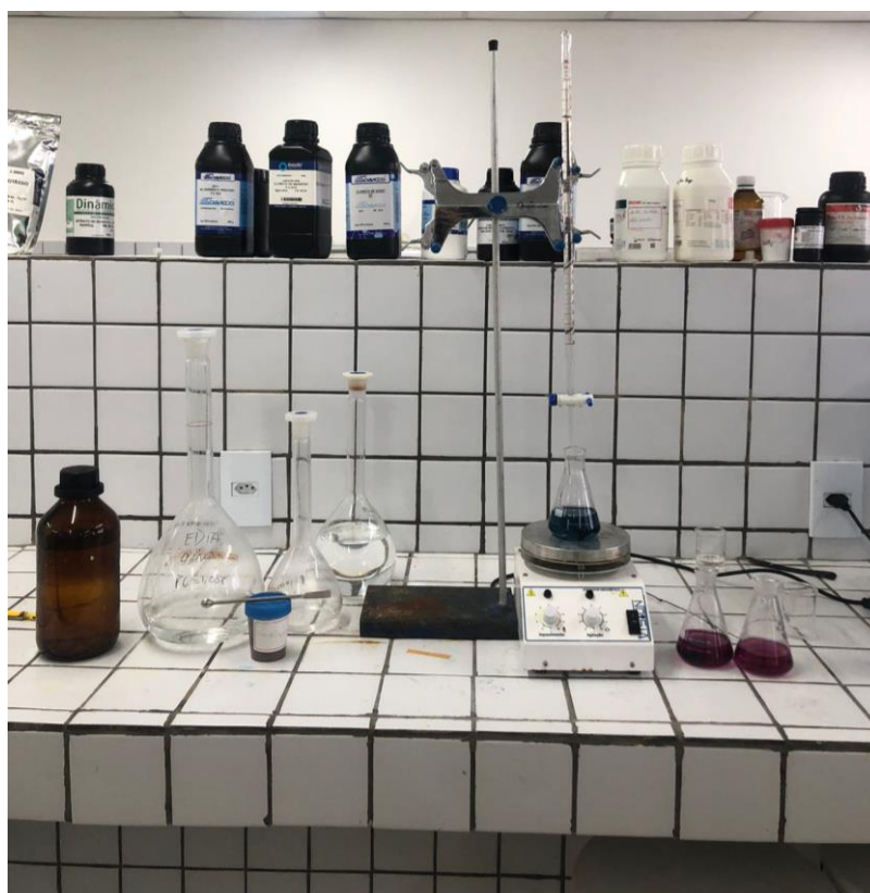
Figura 4. Determinação do percentual de íons de cálcio em amostra de água-mãe. (Autoria própria)
