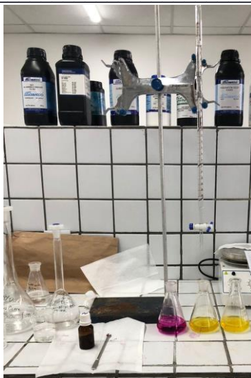
Figura 8. Titulação de pureza do hidróxido de magnésio. (Autoria própria)
