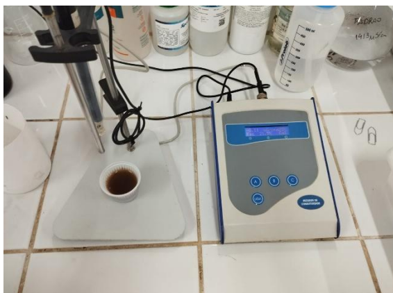
Figura 10: Medição do pH em pHmetro
