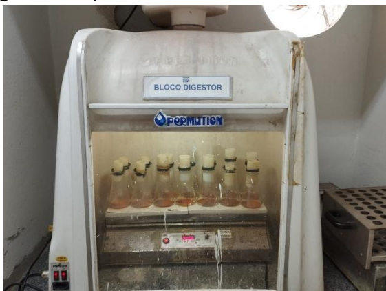
Figura 12: Aquecimento das amostras em bloco digestor
