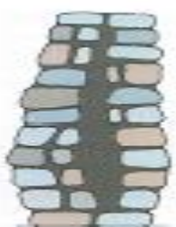
Figura 34 - Abaulamento da Parede sem Perpianho
