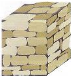
Figura 32 - Montagem de Blocos com Juntas Desfasadas
