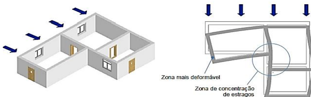
Figura 50 - Efeitos das irregularidades em planta no comportamento sísmico de edifícios
