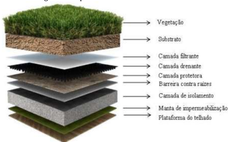
Figura 1 - Esquema das camadas de um telhado verde.
