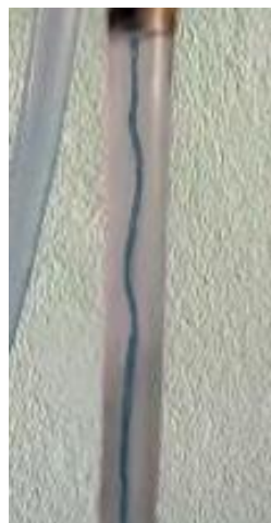
Figura 23 – Escoamento em transição alcançado na bancada final.
