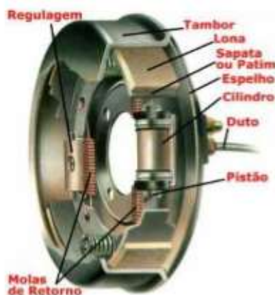
Figura 3 – Componentes do freio a tambor.
