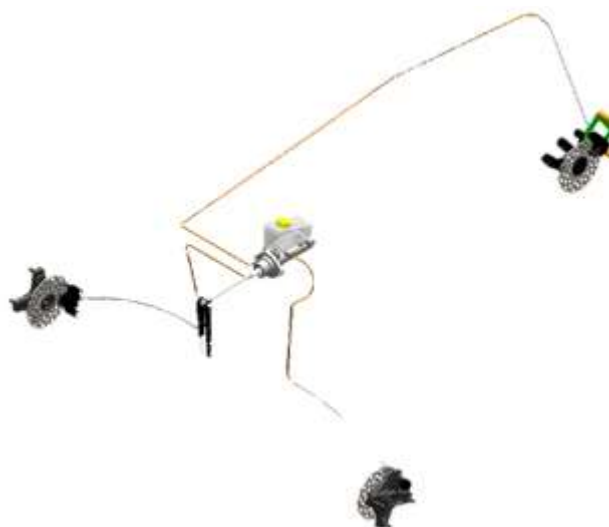
Figura 19 – Distribuição atual do circuito de freio do CB19
