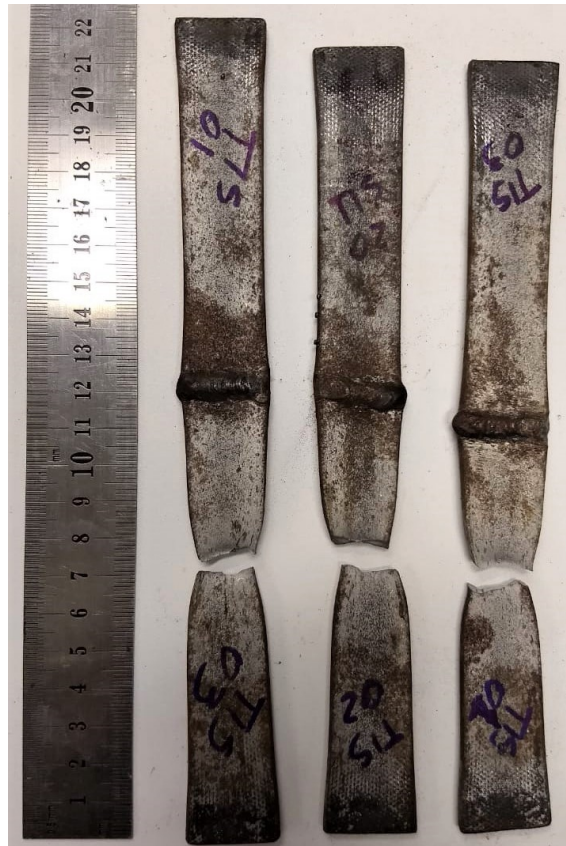
Figura 22 - Corpos de prova com tratamento térmico de 15 minutos, após ruptura.
