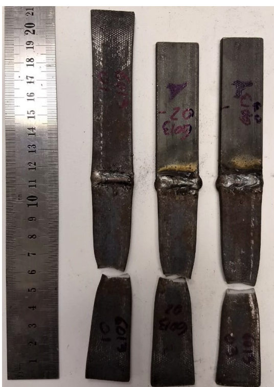
Figura 20 - Corpos de prova sem tratamento térmico, após ruptura.
