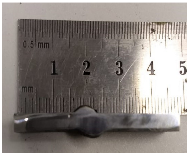
Figura 15 – Corpo de prova cortado para ensaio de microdureza
