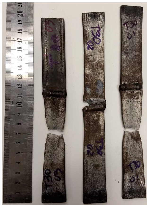
Figura 24 - Corpos de prova com tratamento térmico de 30 minutos, após ruptura.
