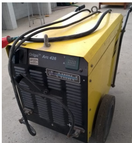
Figura 12 - Máquina retificadora utilizada para soldagem
