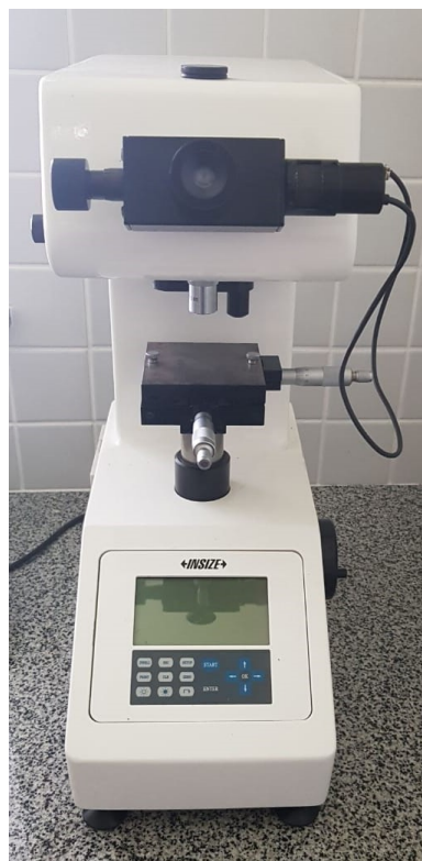
Figura 18 - Microdurômetro utilizado para ensaios de microdureza Vickers.
