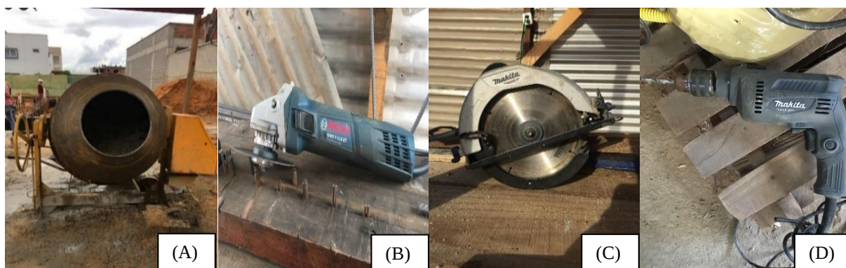
Figura 1. (A) Betoneira; (B) Lixadeira de aço; (C) Serra circular portátil; (D) Furadeira. (Arquivo pessoal)
