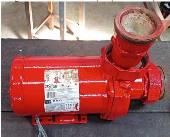
Figura 23- Bomba de recalque após manutenção.
