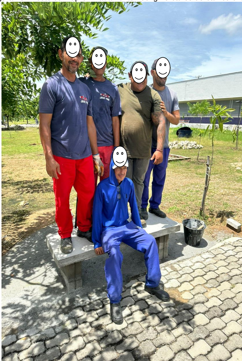
Figura 13 - Teste com aproximadamente 400kg no banco de bambu criado.
