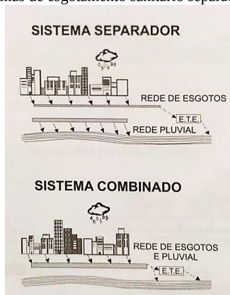
Figura 3 - Sistemas de esgotamento sanitário separador e combinado.
