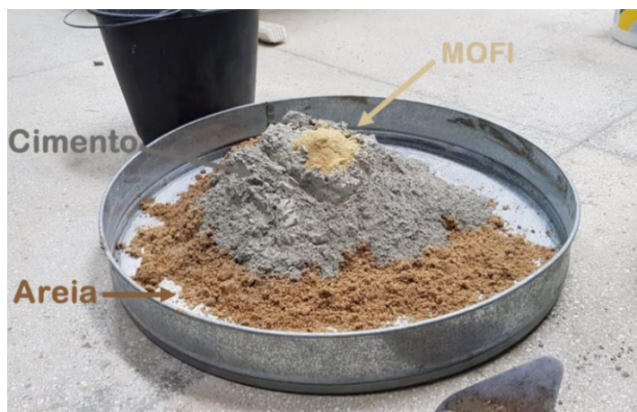
Figura 28: Mistura prévia dos materiais secos (cimento, areia e MOFI)
