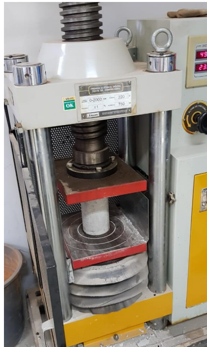
Figura 32: Ensaio de compressão axial do concreto
