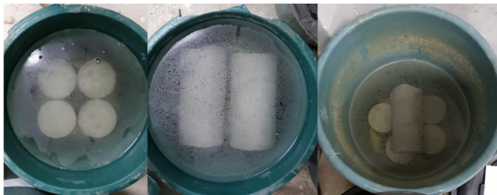
Figura 30: Corpos de prova em cura úmida
