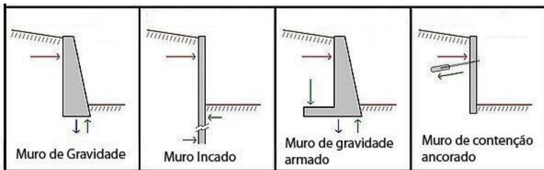
Figura 4: Principais tipos de muros de contenção
