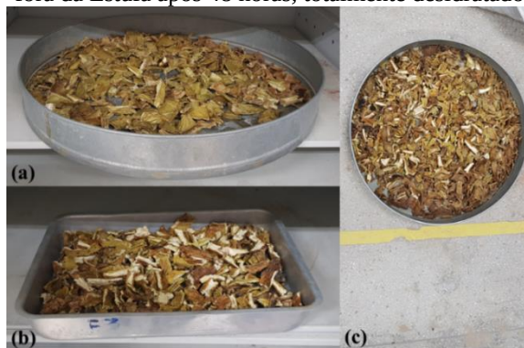
Figura 26: Cacto Opuntia Ficus Indica desidratado: (a) e (b) na Estufa durante o processo de desidratação, (c) fora da Estufa após 48 horas, totalmente desidratado
