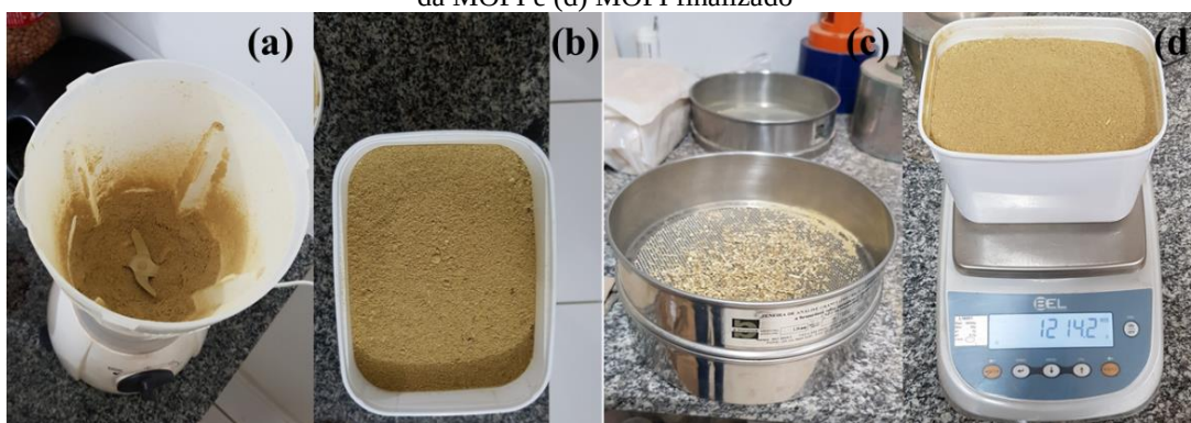
Figura 27: MOFI - (a) triturando o cacto no liquidificador, (b) volume total do cacto triturado, (c) peneiramento da MOFI e (d) MOFI finalizado
