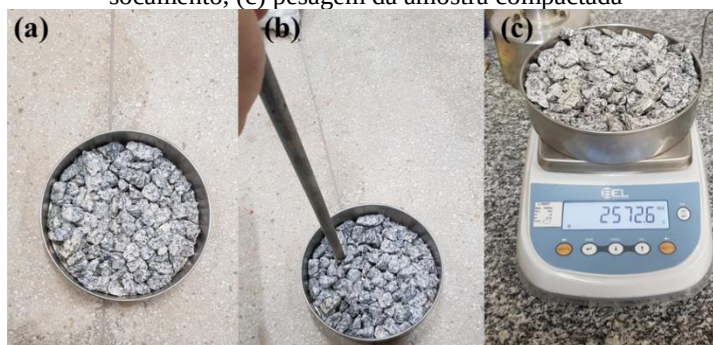
Figura 22: Procedimento para a massa unitária compactada da brita - (a) 1/3 do volume, (b) golpes com haste de socamento, (c) pesagem da amostra compactada
