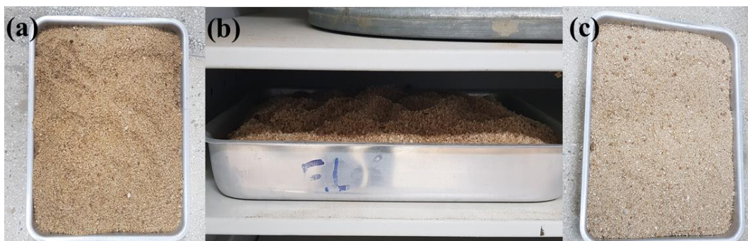
Figura 17: (a) Amostra da areia, (b) amostra em estufa, (c) amostra seca
