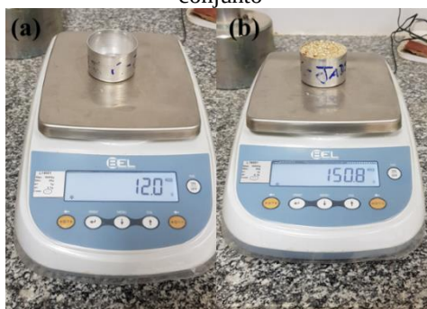
Figura 19: Procedimento para obtenção da massa unitária da areia - (a) massa do recipiente, (b) massa do conjunto
