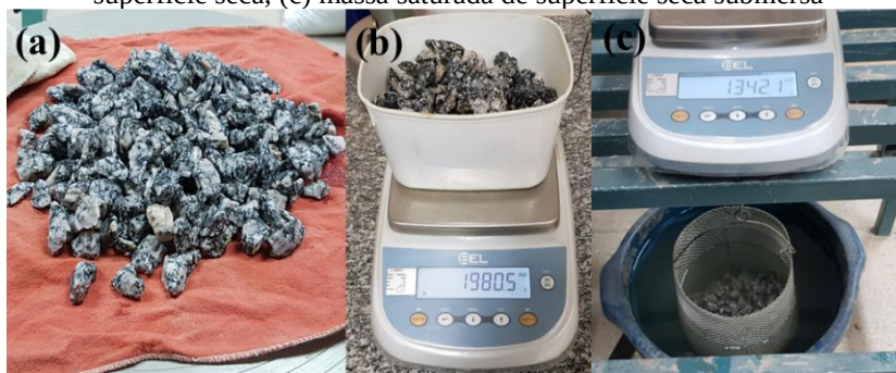
Figura 21: Massa específica da brita - (a) amostra sendo secada superficialmente, (b) massa saturada de superfície seca, (c) massa saturada de superfície seca submersa
