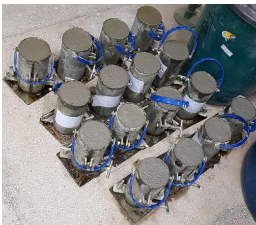
Figura 29: Corpos de prova moldados
