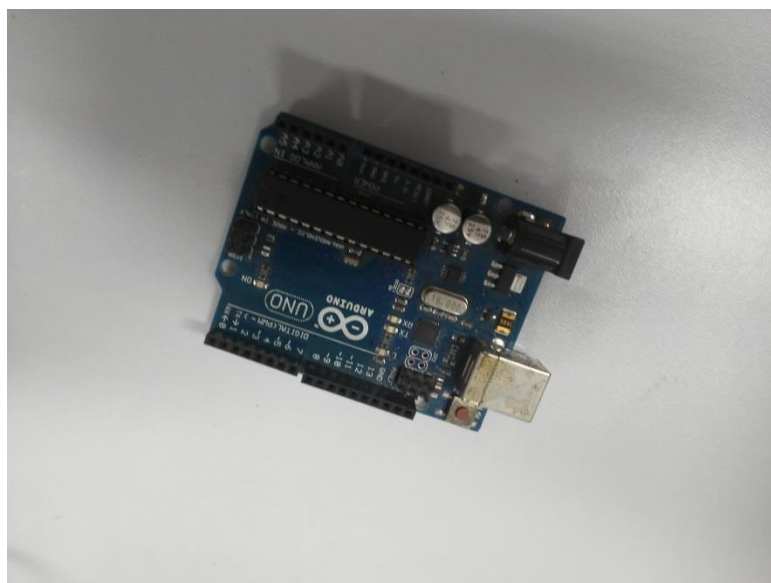
Figura 9: Arduino UNO ® utilizado no projeto do controlador.
