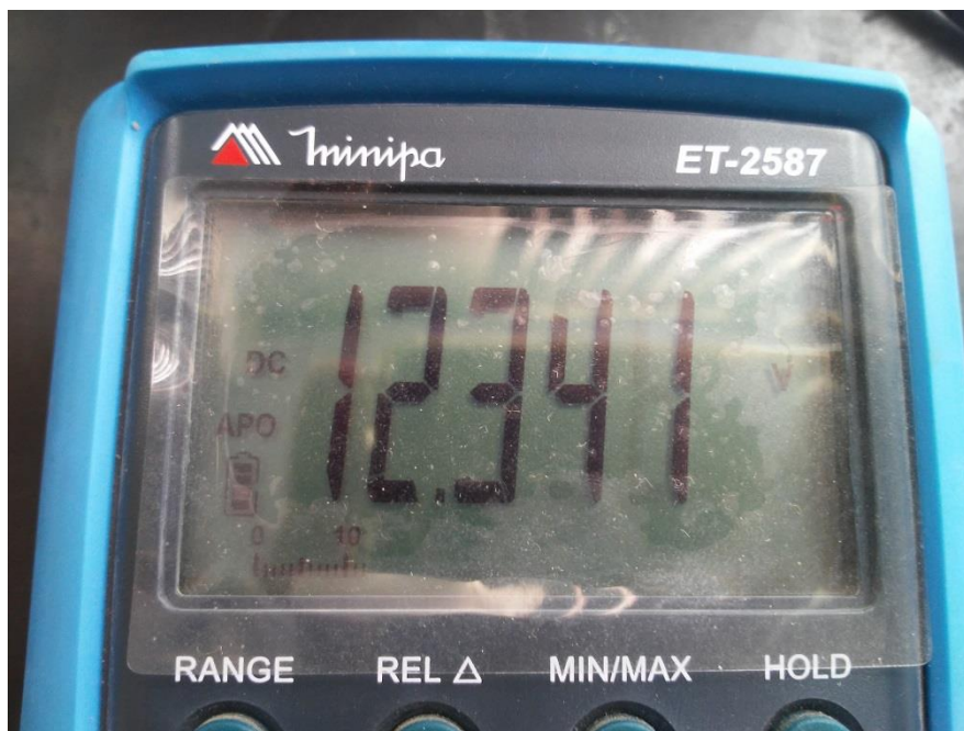
Figura 27: Tensão na saída do controlador, aplicada à bateria.
