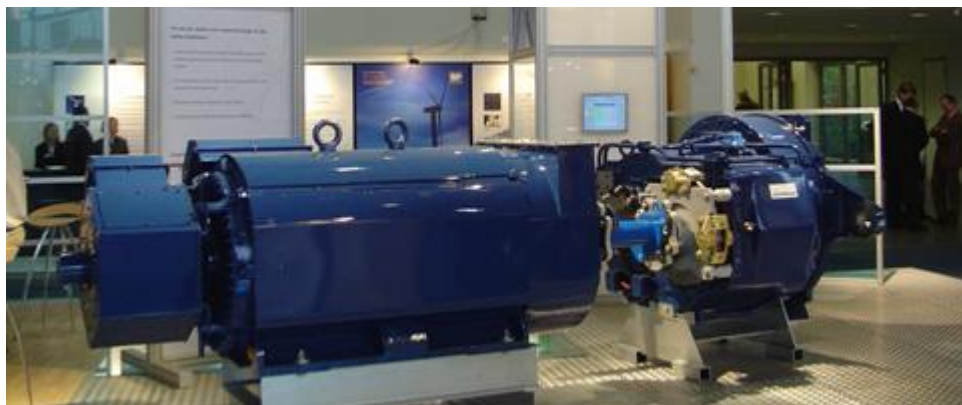
Figura 22 - Gerador conectado a uma caixa multiplicadora.
