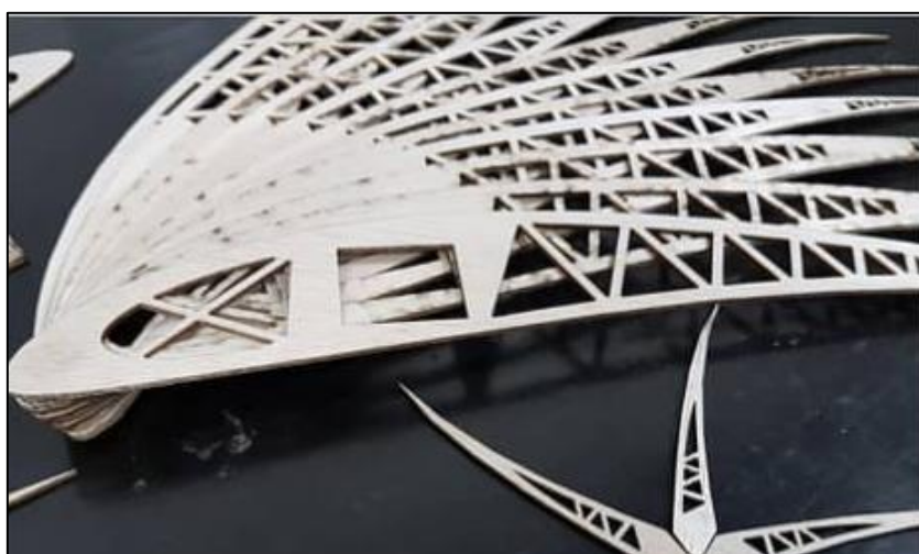
Figura 4. Cortes de perfis de madeira balsa efetuados a laser. (Autoria própria)
