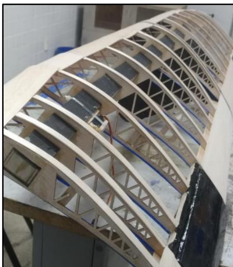
Figura 8. Longarina caixão em asa da equipe PegAzuls 2018. (Autoria Própria)
