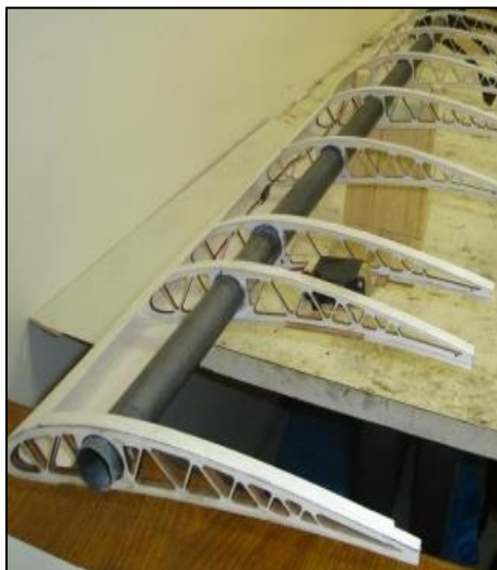
Figura 7. Longarina tubular de fibra de carbono em asa. [5]
