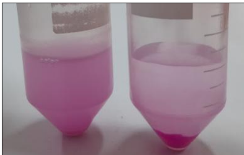
Figura 33 – Antes e depois da interação por 60 minutos de tempo de equilíbrio entre o corante e o MIP.
