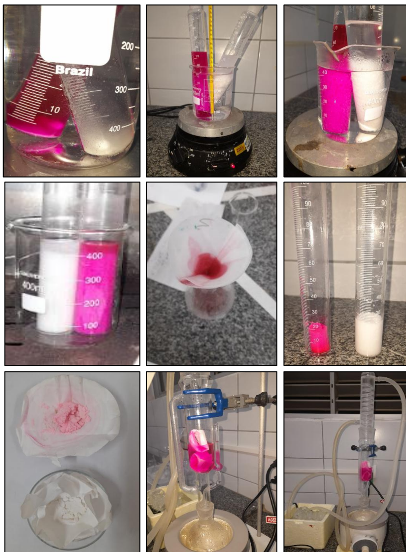
Figura 5 – Síntese, filtração, secagem, maceração e lavagem dos polímeros.
