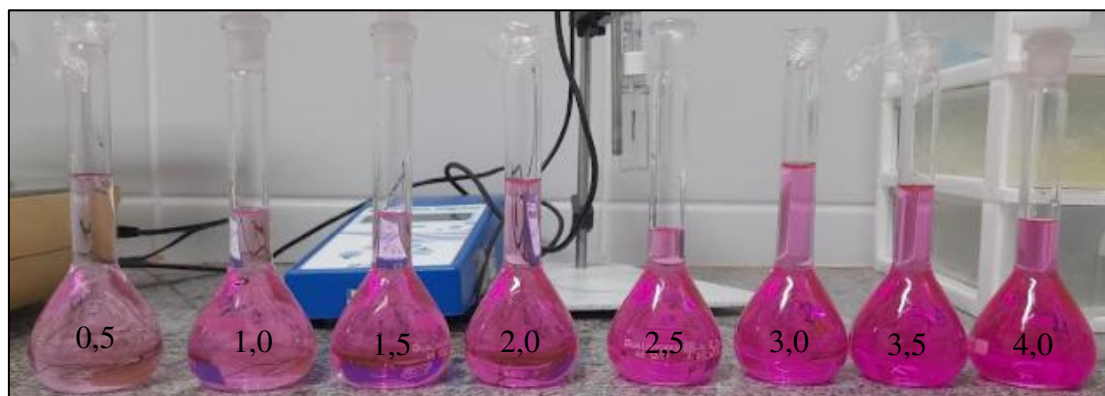
Figura 8 – Soluções de 0,5 a 4 ppm do corante Rodamina B analisadas no espectro do UV-Vis.
