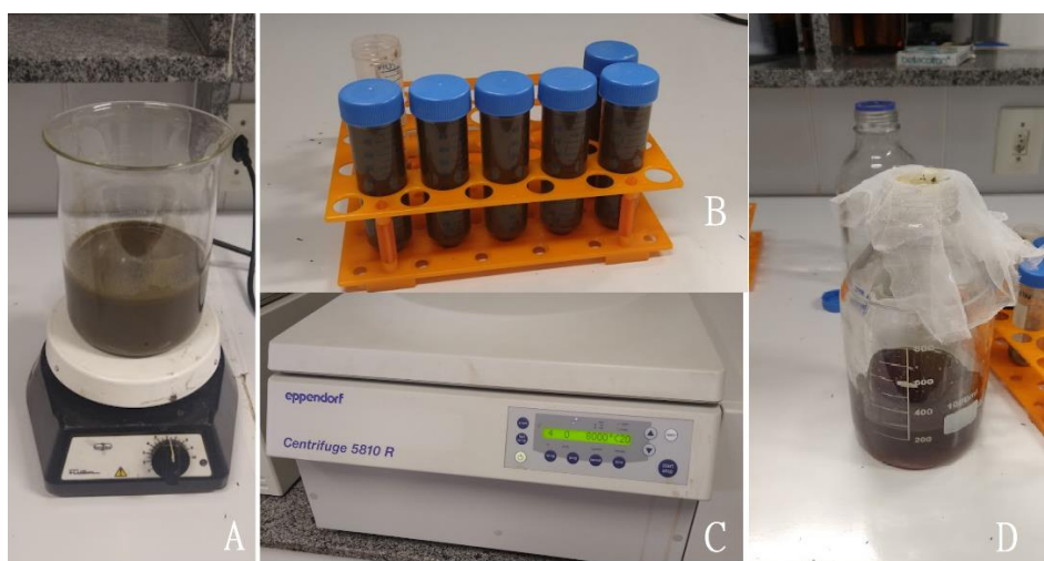
Figura 8- Obtenção do extrato aquoso. Em (A) agitação magnética; em (B) e (C) material direcionado a centrifugação; em (D) filtração utilizando malhas finas. (Fonte: autoria própria).
