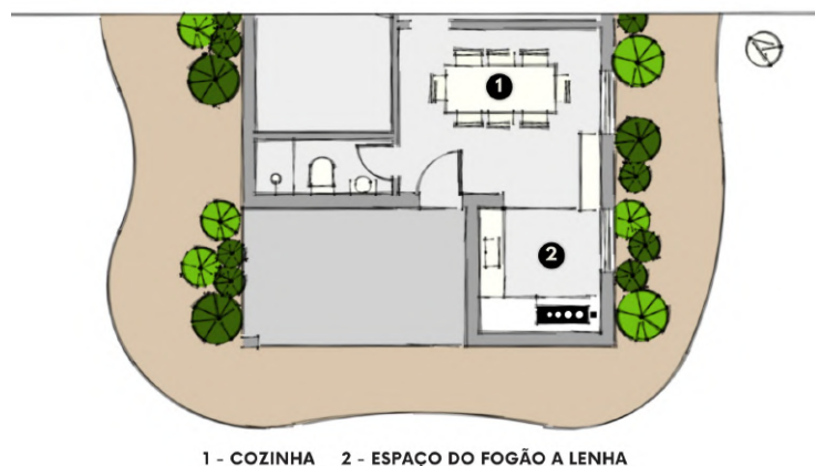
Figura 33: Compartimento que divide a cozinha e a área do fogão a lenha
