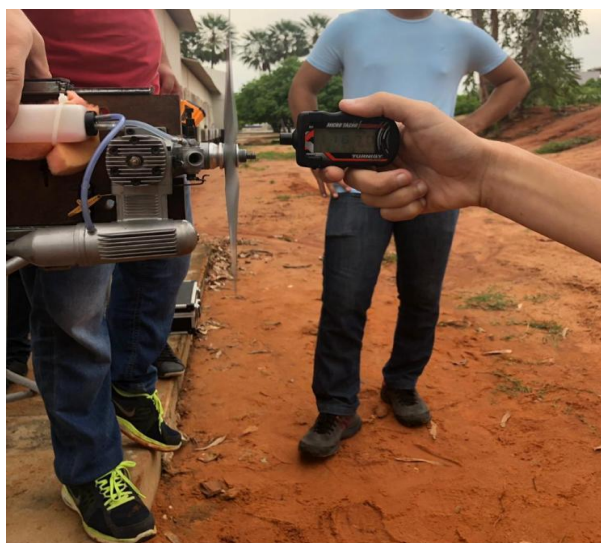
Figura 2. Medição do RPM com o tacômetro. (Autoria própria, 2019)
