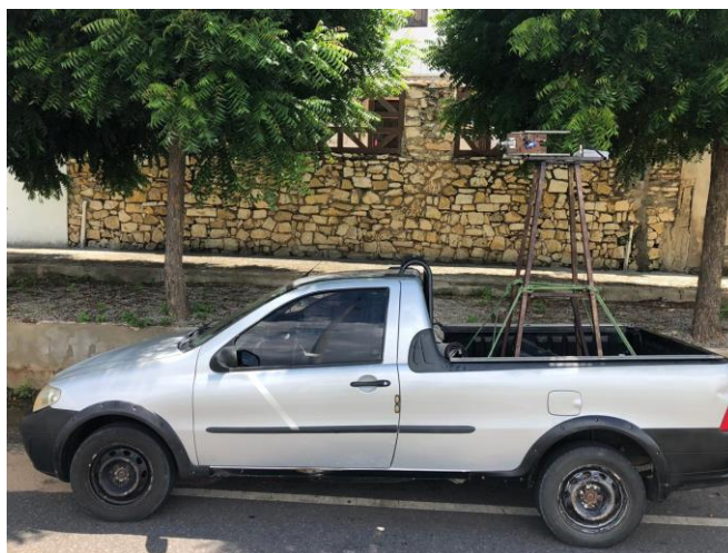
Figura 3. Instalação de estrutura metálica acoplada a pick-up. (Autoria própria, 2019)
