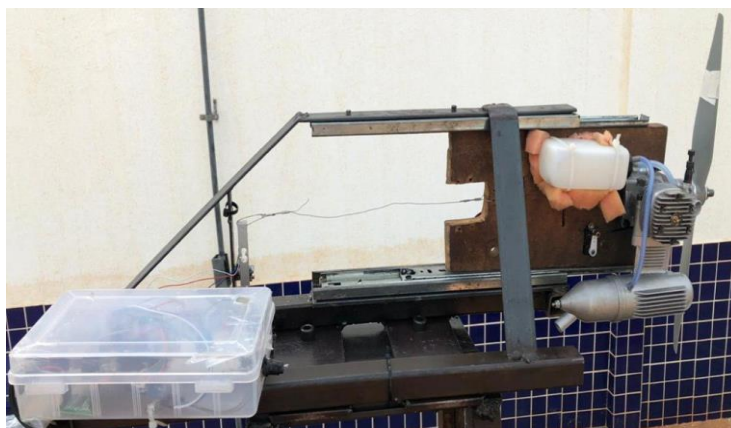
Figura 1. Motor acoplado à bancada de ensaio estático. (Autoria própria, 2019)
