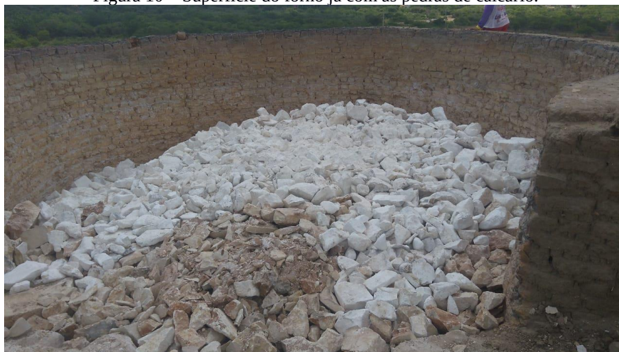
Figura 10 – Superfície do forno já com às pedras de calcário.
