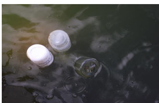
Figura 18: Funis submersos após instalados
