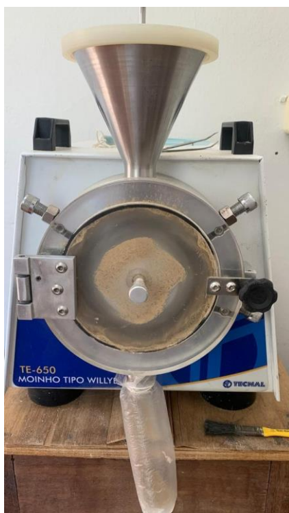
Figura 9- Triturador com peneira de 1 mm.
