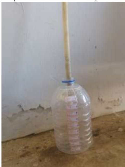
Figura 13 - Medição do bloco administrativo (dreno no mini depósito)
