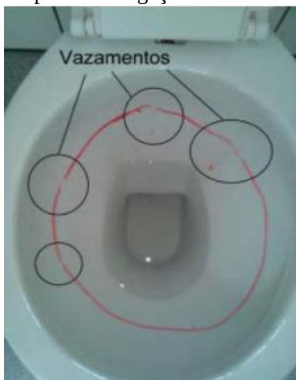
Figura 4 - Teste da caneta para investigação de vazamentos em bacias sanitárias
