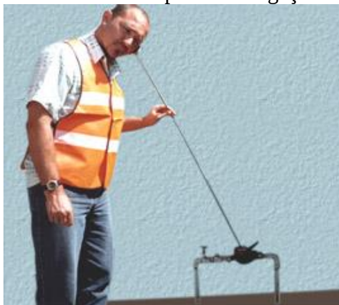
Figura 5 - Haste de escuta mecânica usada para investigação de vazamentos não visíveis
