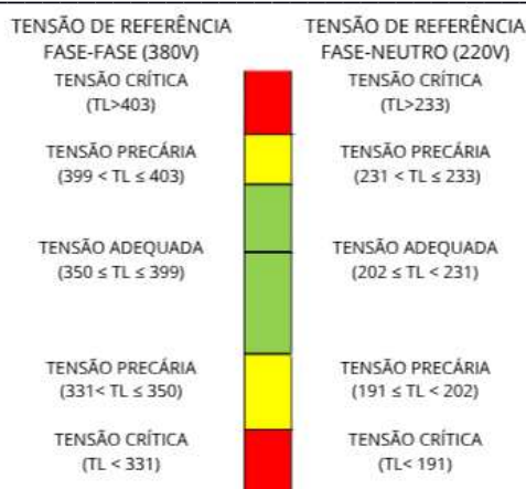
Figura 1. Faixa de tensão de leitura (TL) em relação a tensão de referência. (Adaptado de [5])
