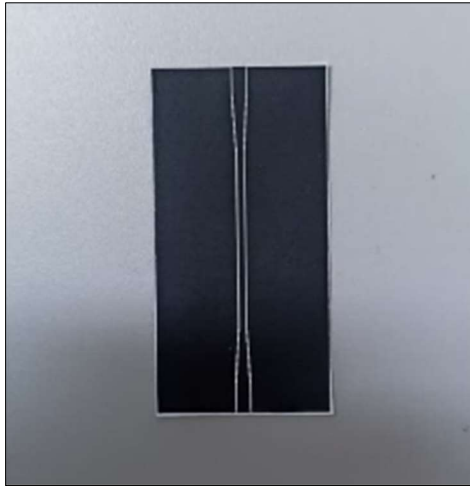
b) Máscara de layout gerada no KiCad .
