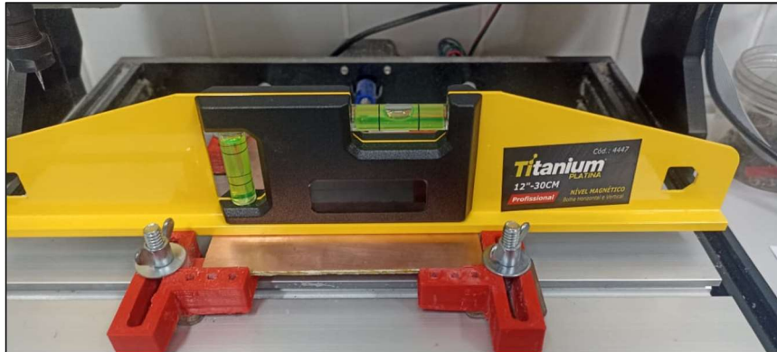
Figura 22 - Nivelamento da placa.
