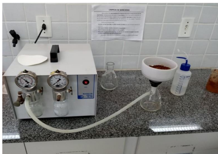
Figura 9. Aplicação da sucção e coleta do filtrado
