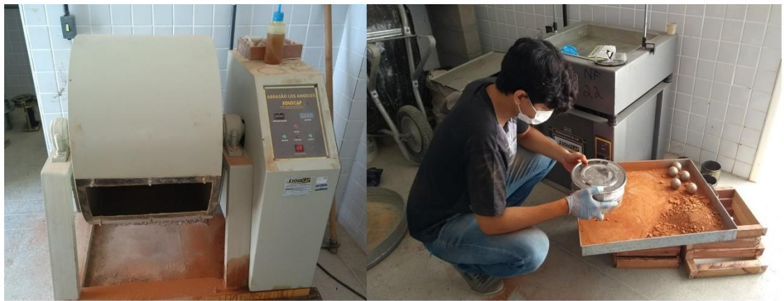
Figura 7. Trituração e peneiramento das amostras.
