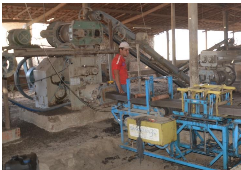
Figura 7 – Extrusão e corte do material cerâmico
