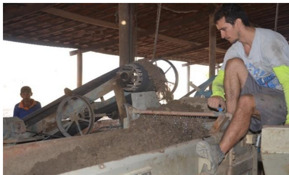
Figura 4 – Preparação da massa cerâmica
