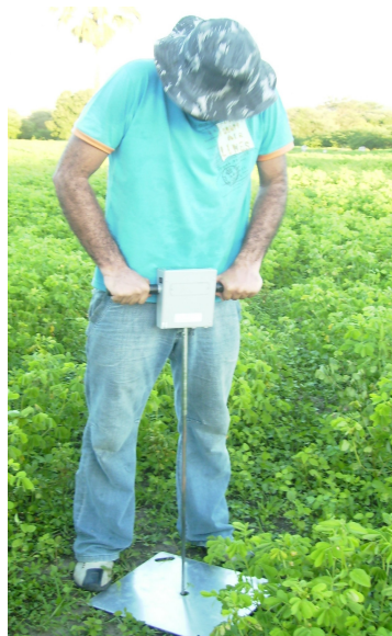
Figura 1 Trabalho de determinação da resistência mecânica do solo à penetração com o penetrógrafo FALKER PenetroLog – PLG1020.
