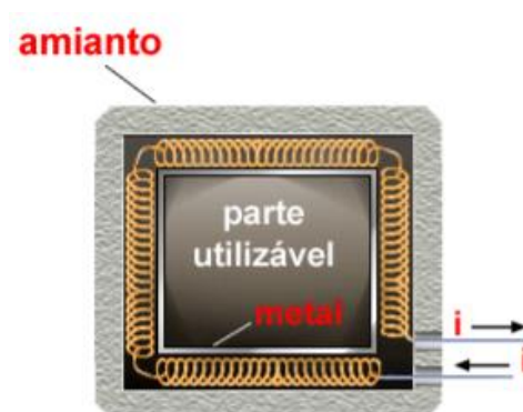
Figura 6: Demonstração do Efeito Joule no Forno.
