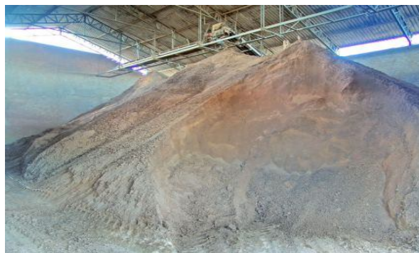
Figura 3 - Armazenamento de argila (para fabricação de telhas)
