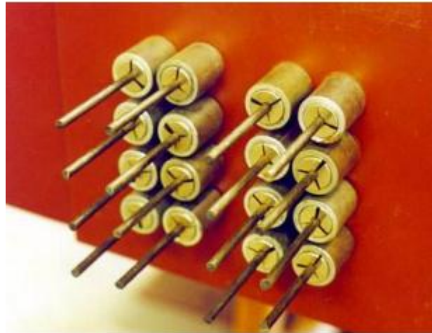
Figura 7 - Cunhas embutidas em portas-cunha para fixação de fios de protensão.
