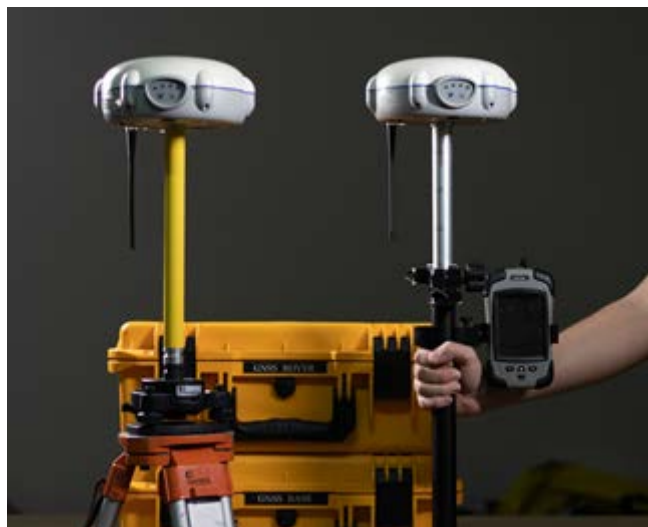
Figura 3: Receptor GNSS RTK utilizado.
