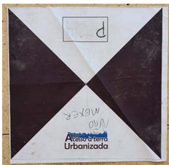
Figura 10: Modelo de alvo pré-sinalizado utilizado
