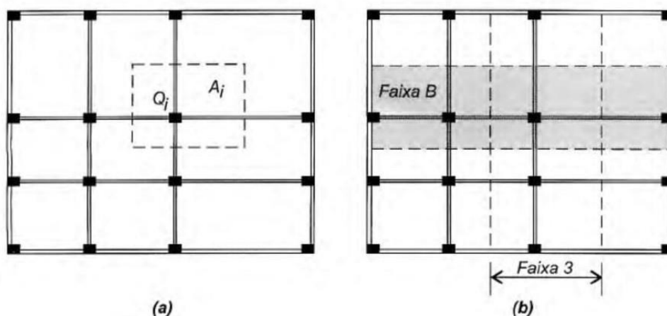
Figura 13 - Esquema de cálculo de um radier (a) pela área de influência e (b) como um sistema de vigas
