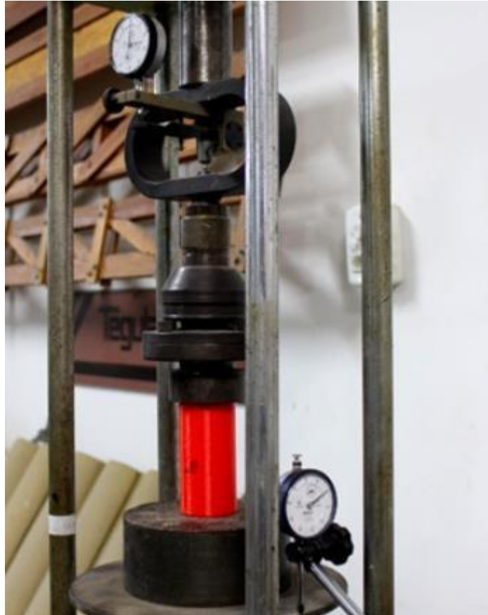
Figura 12 - Esquema de montagem das amostras para o ensaio de compressão axial.
