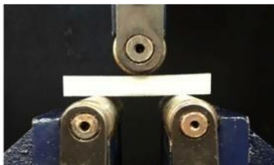
Figura 8 - Posicionamento da amostra para realização do ensaio de flexão em três pontos.
