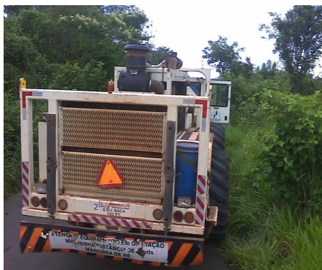
Figura 2. Vibroseis da empresa B utilizado para gerar as ondas sísmicas
