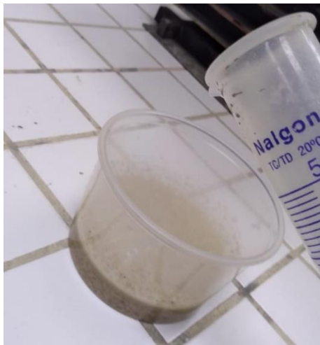
Figura 9 – Aplicação do ácido na amostra
