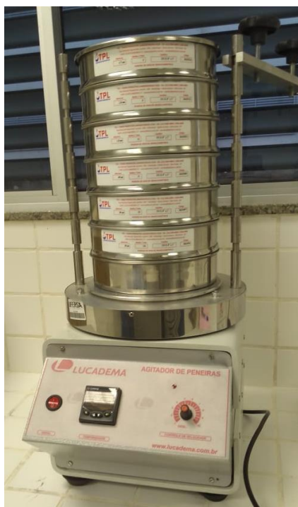
Figura 15 – Peneiras utilizadas no ensaio de granulometria
