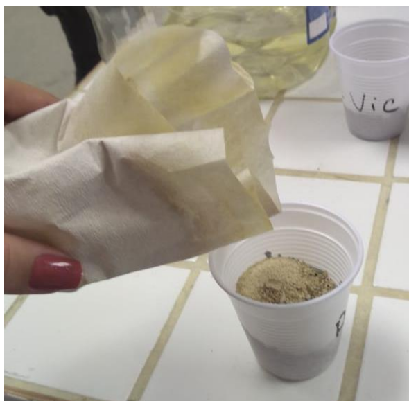
Figura 13 – Retirada da amostra do filtro
