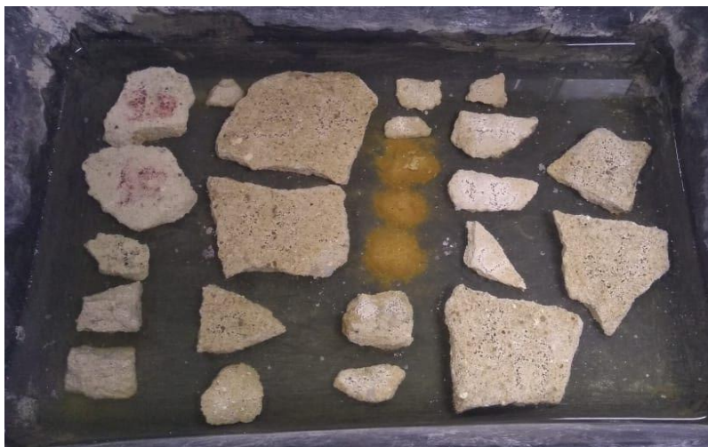
Figura 18 – Amostras submersas em água com ênfase na 05 desintegrada
