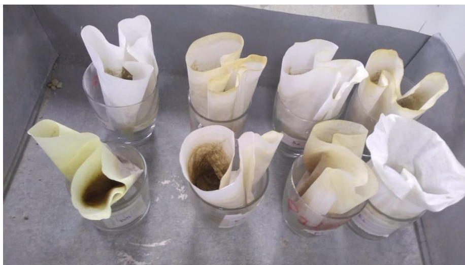
Figura 12 – Amostras saindo da estufa após filtragem
