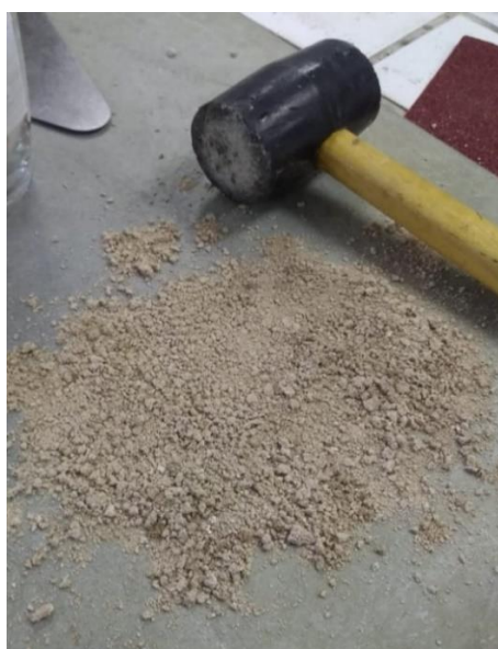
Figura 7 – Destorroamento de uma amostra
