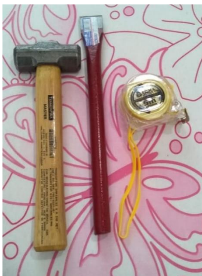
Figura 6 – Ferramentas para extração das amostras
