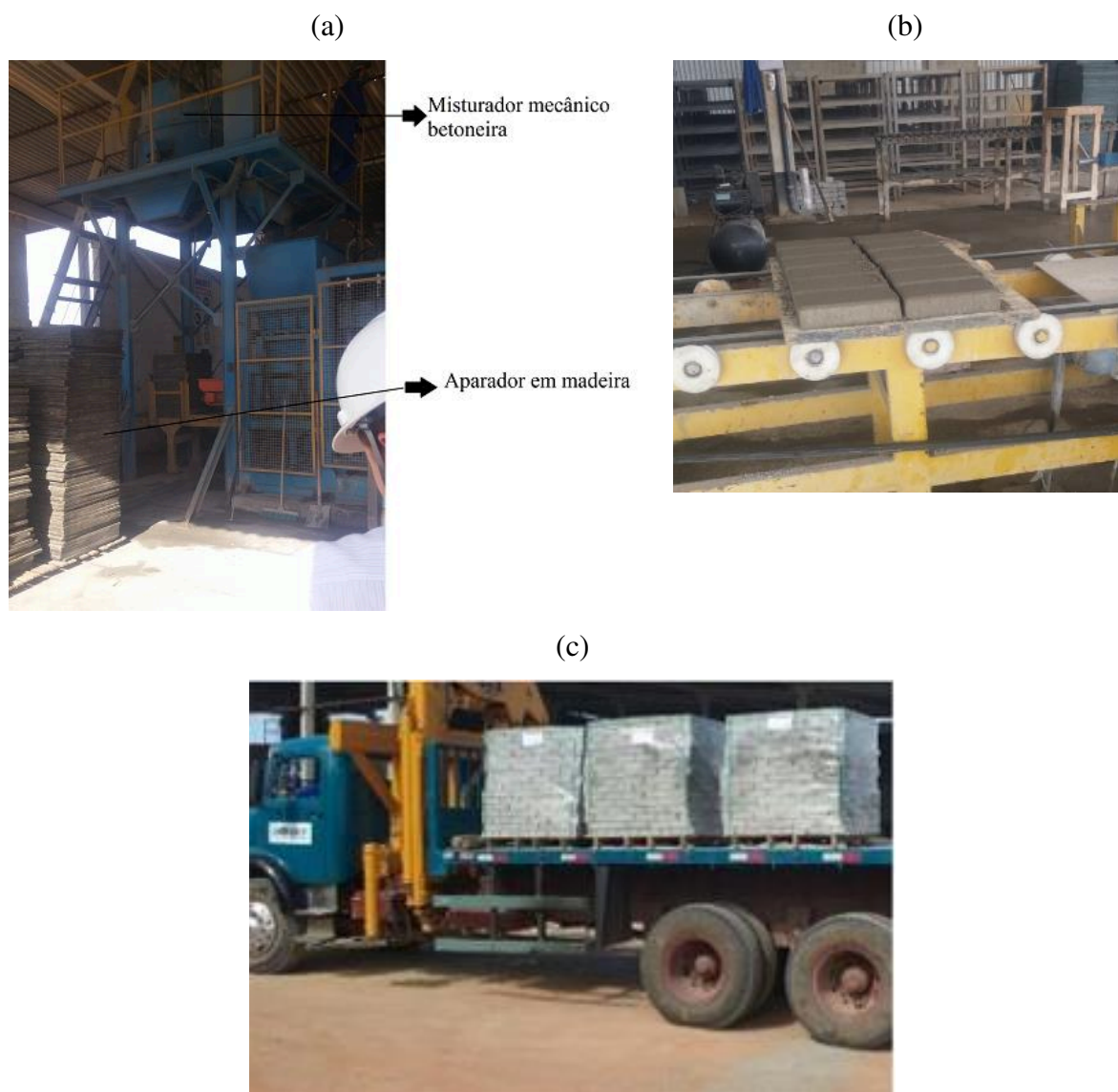
Figura 13: Processo de fabricação dos blocos intertravados (a) misturador mecânico e aparadores; (b) blocos intertravados após saírem da máquina; (c) blocos embalados para distribuição
