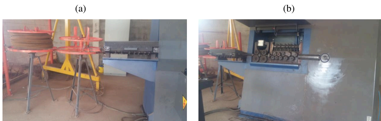
Figura 10: Processo de fabricação das ferragens (a) aço antes de entrar na máquina; (b) máquina para moldagem de estribos
