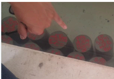
Figura 15: Cura por imersão dos corpos de prova para vigas e pilares
