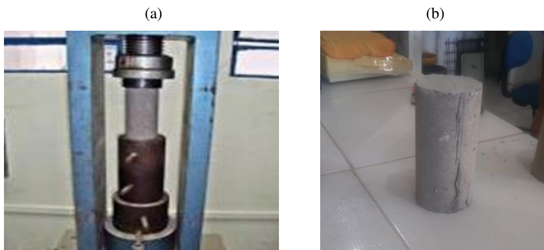
Figura 16: Ensaio de resistência a compressão. (a) corpo de prova na máquina e (b) após ser comprimido
