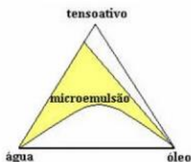
Figura 12. Diagrama ternário mostrando a região de microemulsão em um sistema de três constituintes (VALE, 2009).
