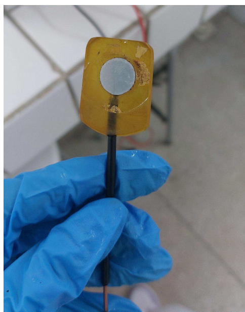
Figura 1: Eletrodo de aço SAE 1020®. (Autoria própria, 2024)
