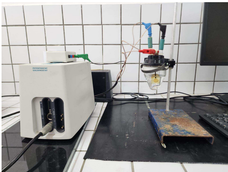
Figura 3: Célula do potenciostato/galvanostato AUTOLAB modelo PG STATE 30 ® . (Autoria própria, 2024)
