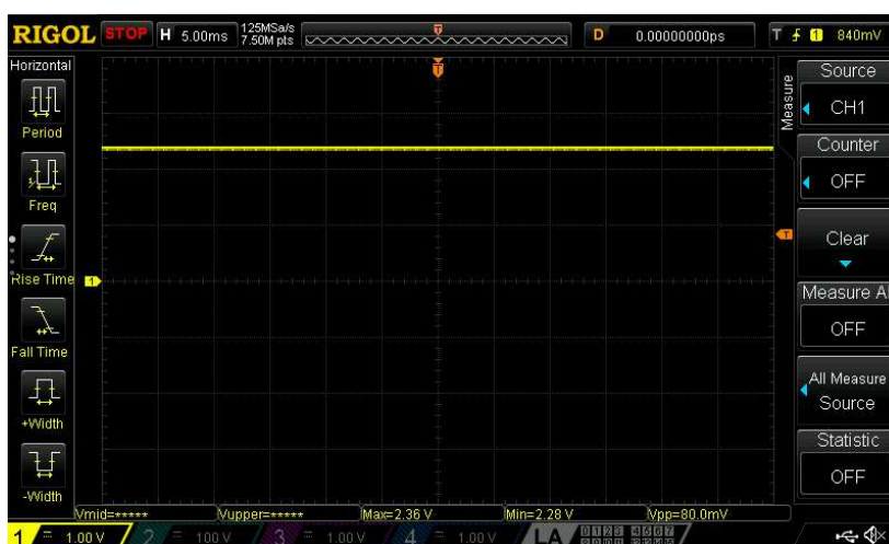
Figura 17 – Sinal de saída do sensor sem sinal em sua entrada.
