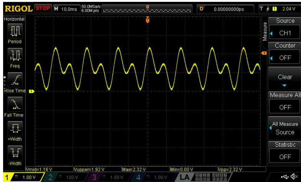
Figura 24 – Sinal aplicado no ESP32 no osciloscópio.
