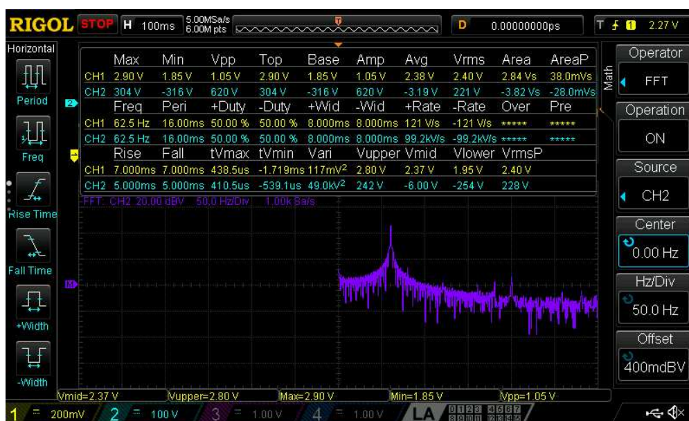
Figura 32 – FFT aplicada pelo osciloscópio para medição complementar.
