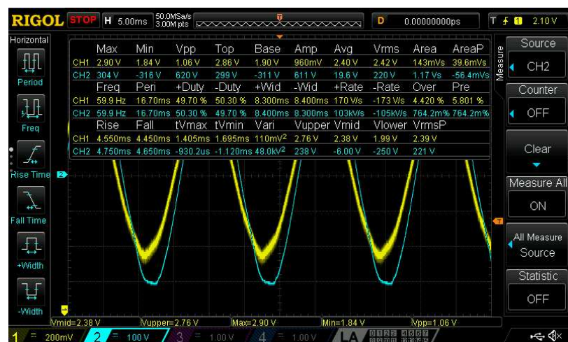
Figura 20 – Dados do comparativo entre o sinal de saída do sensor e o sinal de tensão da rede elétrica.
