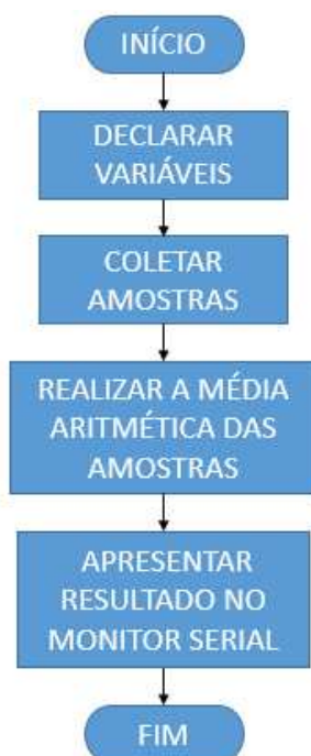
Figura 9 – Fluxograma do código para obtenção do offset .
