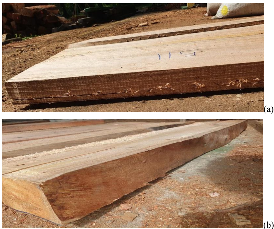
Figura 9. Avaliação do empenamento em tábuas do clone de Eucalyptus VE38 – não empenada (a) e VE41 – empenada (b). Clones de eucaliptos (espécie e híbridos) provenientes do plantio conduzido pela Embrapa Agroindústria Tropical e Embrapa Florestas, implantado em 2011 no município de Acaraú – CE.
