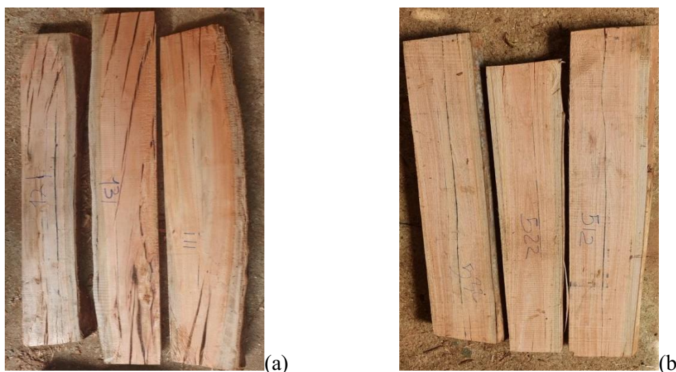
Figura 7. Avaliação das rachaduras em tábuas do clone de Eucalyptus AEC1528 – rachadas (a) e VE41 – sem rachaduras (b). Clones de eucaliptos (espécie e híbridos) provenientes do plantio conduzido pela Embrapa Agroindústria Tropical e Embrapa Florestas, implantado em 2011 no município de Acaraú – CE.
