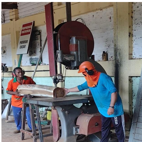
Figura 4. Obtenção de tábuas através de serra fita vertical na serraria da Copan Agroindustrial, em Icapuí/CE do material vegetal proveniente do plantio conduzido pela Embrapa Agroindústria Tropical e Embrapa Florestas em Acaraú/CE.
