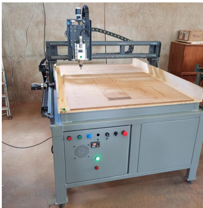
Figura 31 – Furadeira elétrica tipo CNC (Comando Numérico Computadorizado) utilizada para a execução das furações de todas as malhas/redes inspiradas em EBG deste trabalho.
