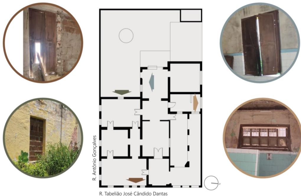
Figura 71 - Tipologia e estado atual das janelas
