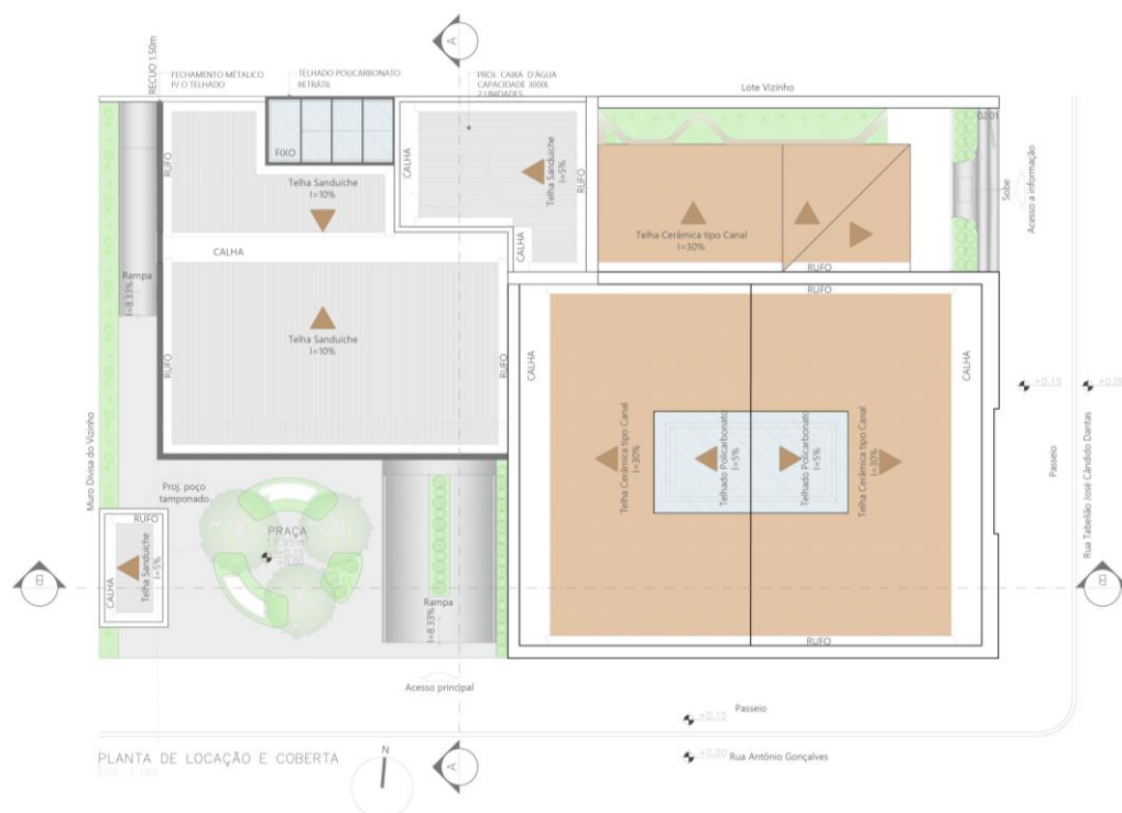
Figura 102 - Planta de locação e cobertura da clínica.
