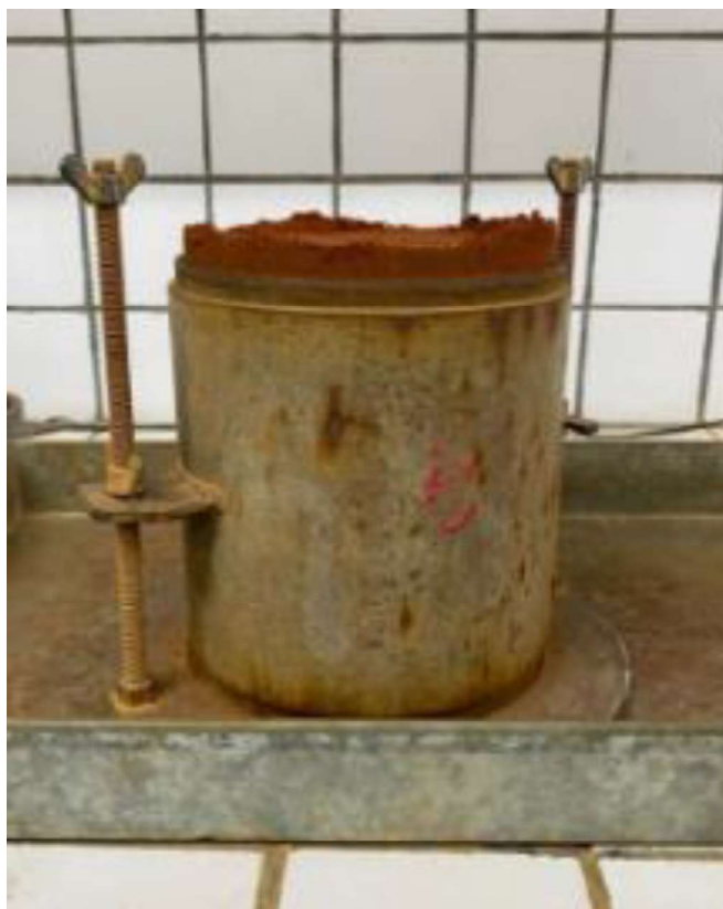
Figura 16 –Ensaio de compactação.
