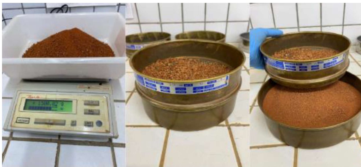
Figura 11 –Preparo de amostra de solos para os ensaios de caracterização.
