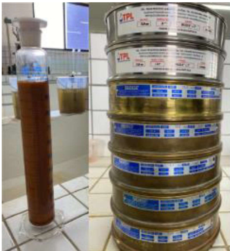
Figura 15 –Ensaio de sedimentação e peneiramento.
