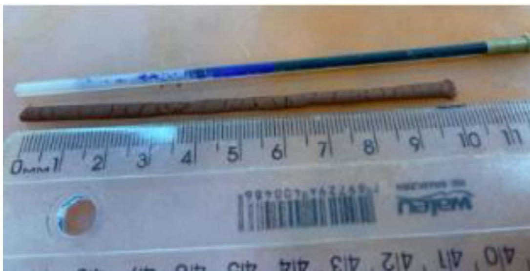
Figura 14 – Molde do solo com 3cm de diâmetro.
